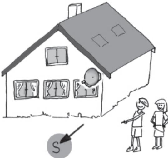
Aber auch mit der modernen Technik kannst Du Dich orientieren: In unseren Breiten sind Satellitenschüsseln normalerweise nach Süden ausgerichtet.
